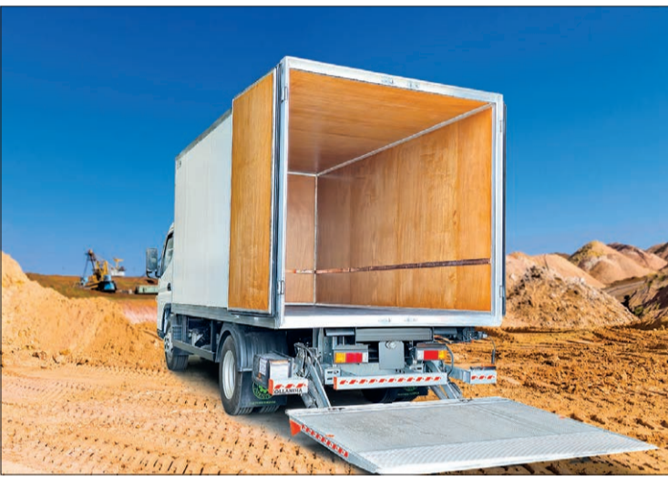
مركبة مخصصة لنقل المواد الخطرة (الغرفة الأولى) مزودة بعزل حراري وحماية ضد الشحنات الساكنة
